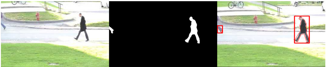
Originalbild einer Videosequenz (links). Binärbild nach der Segmentierung durch PBAS\MOG2 (mitte). Berechnete Bounding Box und Kontur auf dem Originalbild (rechts).
